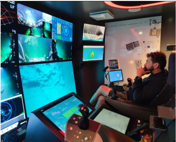
Pengoperasian ROV dari control room
